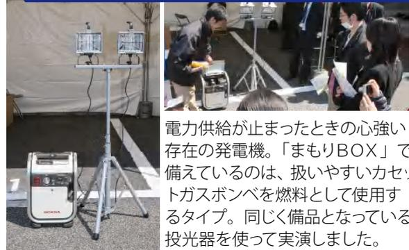
電力供給が止まったときの心強い存在の発電機。「まもりBOX」で備えているのは、扱いやすいカセットガスボンベを燃料として使用するタイプ。同じく備品となっている投光器を使って実演しました。
